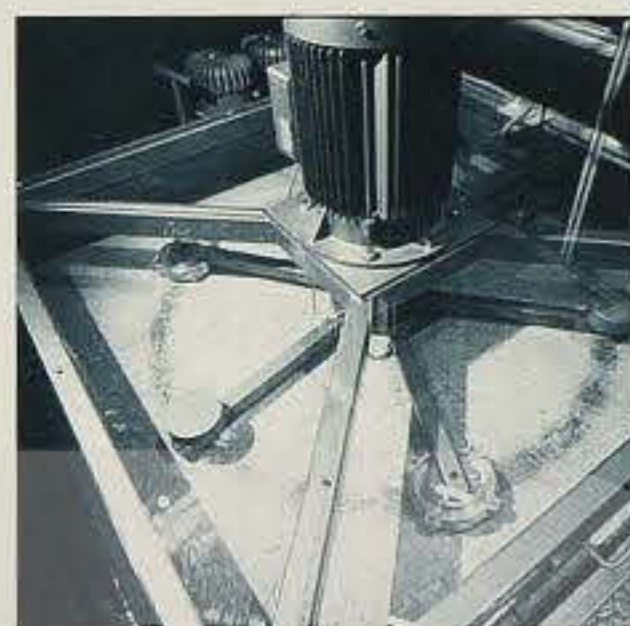
Beim C.A.R.E. Abriebtestgerät werden Geschwindigkeiten bis zu 120 km/h erreicht. Die Materialproben werden über die Teller gedreht, in der Luft beschleunigt und auf harten Untergrund fallen gelassen.
